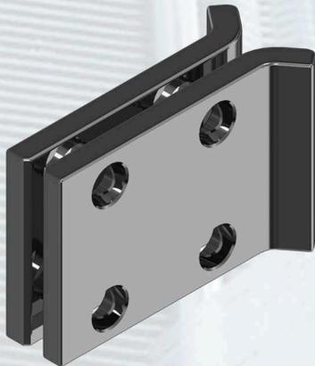
Der Fadeneinlaufbereich der Gleitschuhe ist mit einer feinen Fase versehen. Diese besondere Form sichert einen schonenden Fadenlauf und blockiert nahezu alle Knoten und Schlingen.
